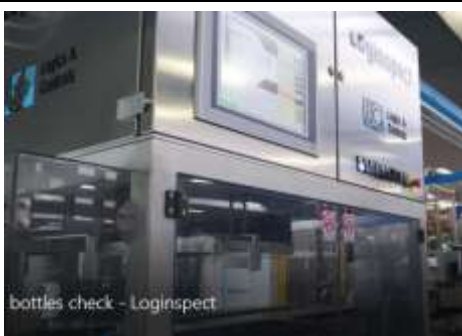
Controllo delle bottiglie e scarto di quelle difettose
