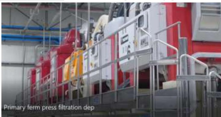
Al fine di diminuire la frazione solida presente nel prodotto si procede alla pulizia del mosto, operazione che, a seconda dei casi, può essere effettuata nei seguenti modi: decantazione statica (con eventuale enzimaggio), flottazione e/o chiarifica, filtrazione sotto vuoto o mediante filtro tangenziale.
