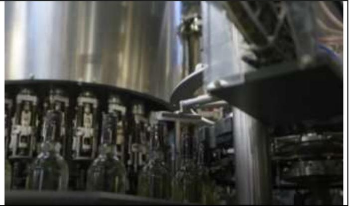
Controllo della presenza e del corretto posizionamento della capsula/tappo ; espulsione dei campioni non conformi
